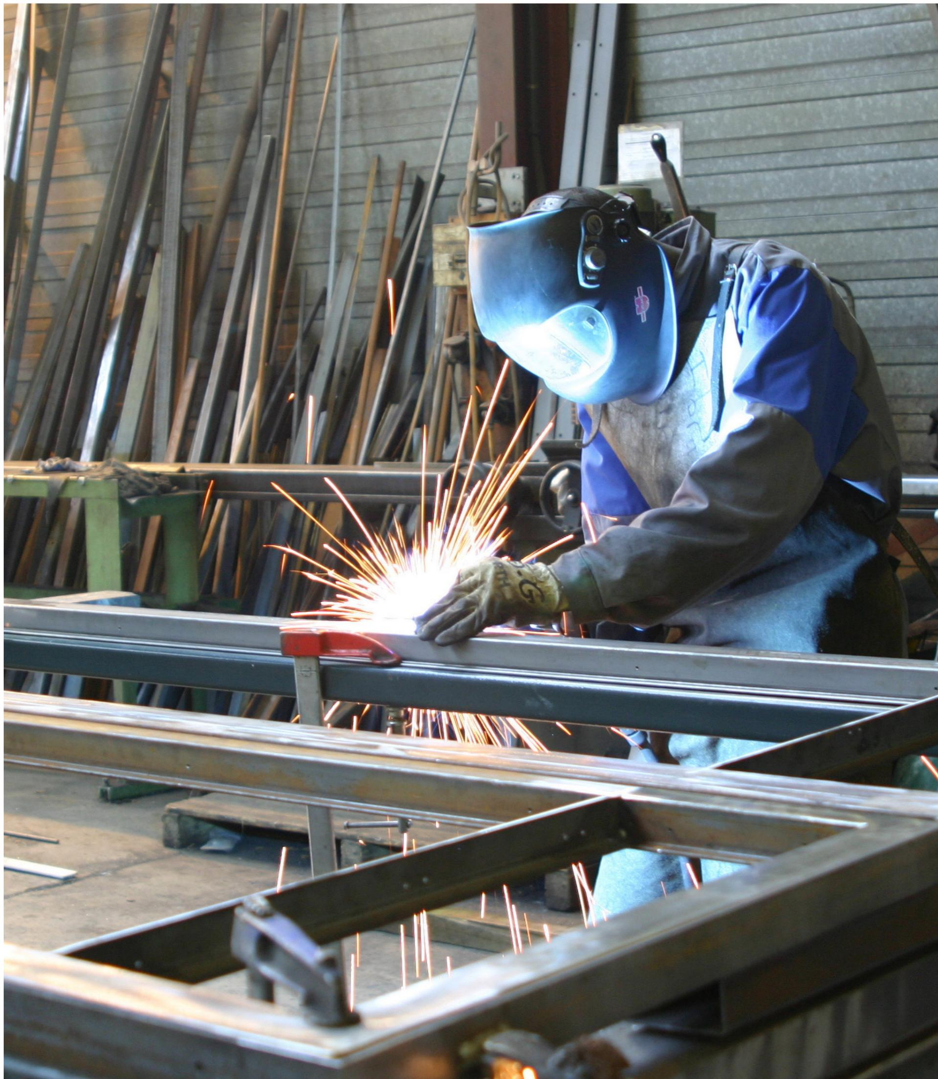
Le métallier construit les ouvrages métalliques destinés à la construction et à l'aménagement de bâtiments. Les productions courantes sont les grilles de défenses, garde-corps, portes, portails et autres fermetures, le mobilier urbain et aussi les structures métalliques telles que mezzanines, escaliers, rack.
